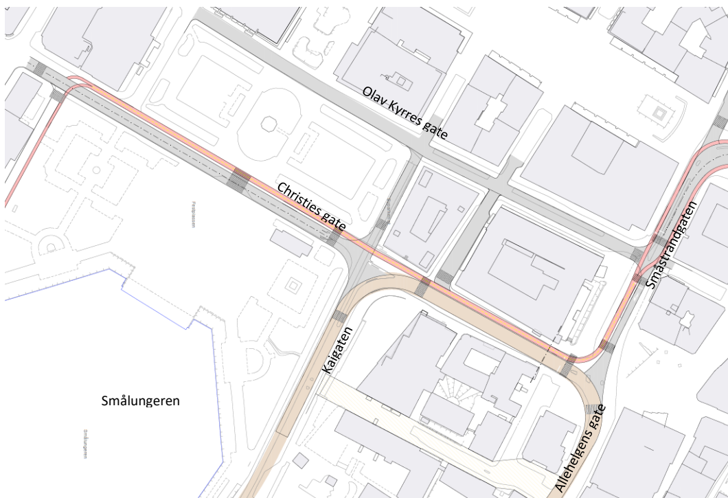
Figur 4-31: Skisse til hovedsykkelrute og trafikkløsning mellom Rasmus Meyers Allé og Småstrandgaten.
