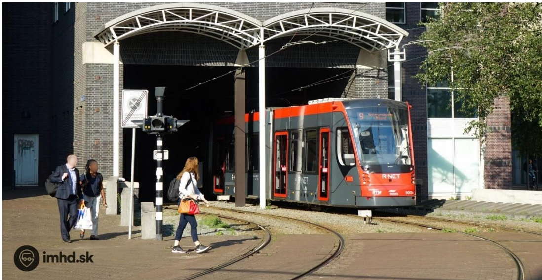
Figur 3-46: Eksempel på fotgjengerkryssing i nærheten av tunnelportal for bane. Overgangen mellom spor og fotgjengerkryssing markeres med bane på pukk. Fra den Haag i Nederland, Foto: Insider – www.imhd.sk .
